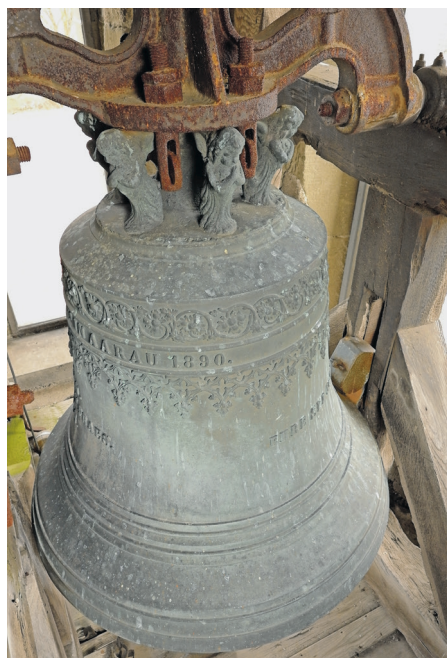
Das Joch, die Krone, die Schulter, die Flanke, der Wolm: aus diesen Teilen ist die Glocke gefertigt.
